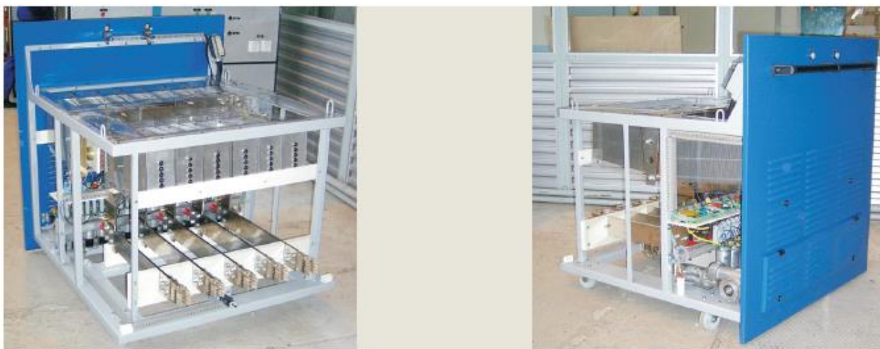
Два вида на каретку шкафного преобразователя – сзади наверху хорошо видны охладители диодного блока и внизу контактные головки силового подключения
