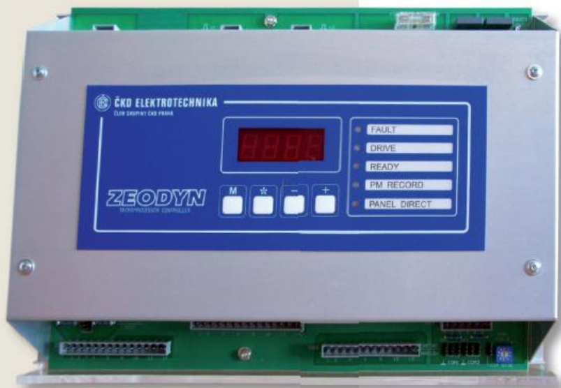
Regulátor ZEODYN s čtyřmístným displejem a 4 tlačítky pro přístup do softwaru
